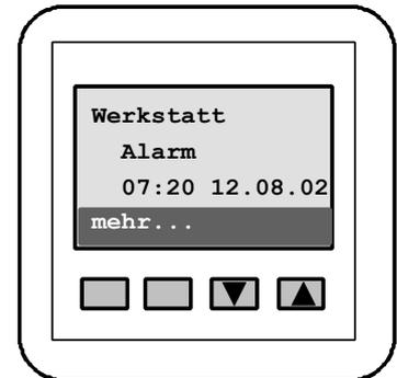
**Hinweis:** Die Anzeige des Ereignisspeichers erfolgt im Zustand „Unscharf nach Alarm“. Auslesen im Zustand „Unscharf“ ist mit einem PC und dem Programmpaket ETS2 ab Version 1.2a möglich. Sprechen Sie hierzu mit Ihrem Elektroinstallateur.
