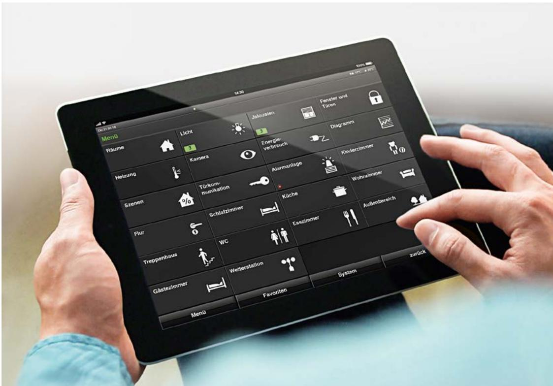
**Abb. oben:** Verknüpft und gesteuert wird das Smart Home vom Gira HomeServer. Intuitiv bedienen lässt es sich z. B. über den Gira G1, der an zentraler Stelle im Haus an der Wand hängt.
